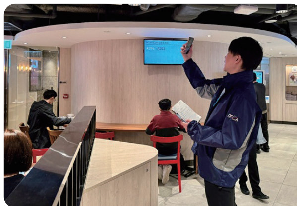
通訊辦職員實地測試一家流動網絡營辦商的室內網絡覆蓋。
