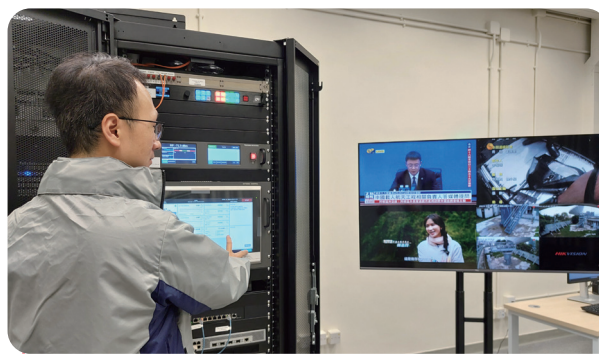
通訊辦職員使用衛星電視廣播監測系統監測在香港可接收的衛星電視訊號。
